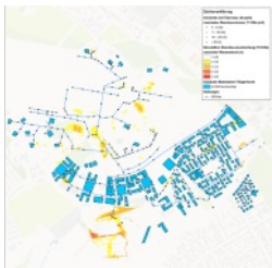
Oberflächenabfluss - Modellierung für Starkregen T = 100 Jahre
